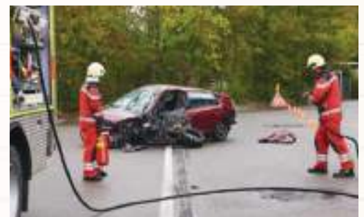
I veicoli incidentati dotati di sistemi ad alta tensione comportano diversi rischi, ad es. archi elettrici, pericolo d'incendio provocato dalla fuoriuscita di liquidi infiammabili e intossicazioni causate dall'inalazione di sostanze tossiche.
